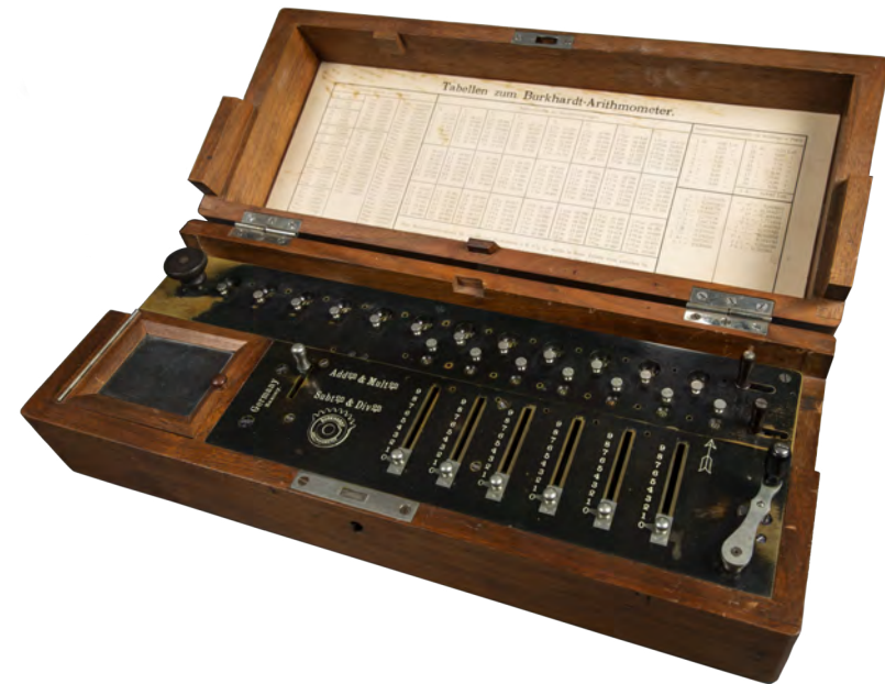
Burkhardt-Arithmometer mit sechsstelligem Eingabewerk und Schnell-Lösch-Mechanismus. Die beiden Lösch-Hebel befinden sich rechts, oberhalb der Kurbel (Foto: ITMZ).
