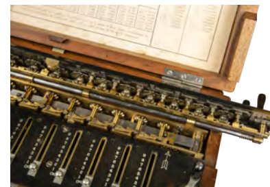
Blick in das Resultats- und Umdrehungszählwerk mit Hebelzug zur Schnell-Löschung (Foto: ITMZ).
