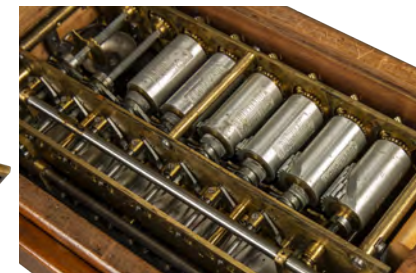
Staffelwalzen auf der zugänglichen Unterseite des Arithmometers (Foto: ITMZ).
