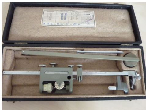
REISS Kompensations-Polarplanimeter 3003 (VEB Mess- und Zeichengerätebau Reiss, Bad Liebenwerda)
