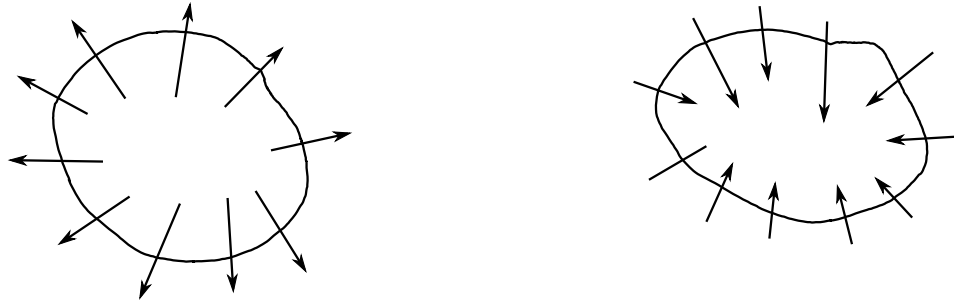
Abbildung 4.22: Links ist eine Quelle mit \operatorname{div} f > 0 , und rechts ist eine Senke mit \operatorname{div} f < 0 .
